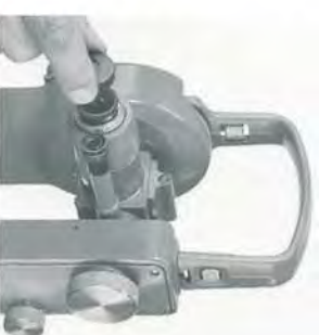
Bild 19 Aufstecken des Okularfilters
