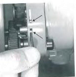
Bild 25 Justierschrauben der Dreifuss-Dosenlibelle
