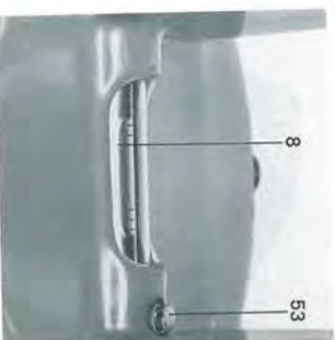
Bild 24 Justierung der Alhidadenlibelle 8 Alhidadenlibelle 53 Justierschraube
