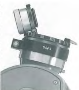
Bild 22 Sonnenprisma heruntergeklappt, zum Anvisieren terrestrischer Ziele
