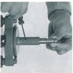
Bild 15 Einstellen des Trägers GRT10 (einfacher Zielmarkensatz) auf Theodolit-Kippachsenhöhe. Schlitzschraube mit Schraubenzieher halb herausdrehen, Zapfen auf den langen Indexstrich »T1/T16« stellen und drehen, bis Schraube in einer Bohrung sichtbar wird. Schraube bis zum Anschlag wieder hineinschrauben.
